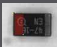
Condensateur orienté à l'envers
